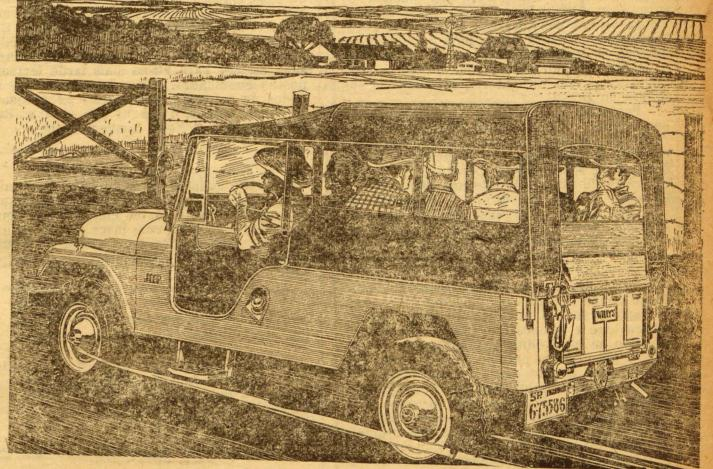
Oferece maior rendimento nas emprêsas que necessitam transporte sistemático de pessoal. Sua distância entre eixos, de 101 polegadas, lhe garante um rodar macio e grande estabilidade em qualquer tipo de estrada. 2 portas, assentos para 8 passageiros. Apresentado em 2 modelos: tração nas 4 rodas e reduzida ou tração em 2 rodas sômente.
