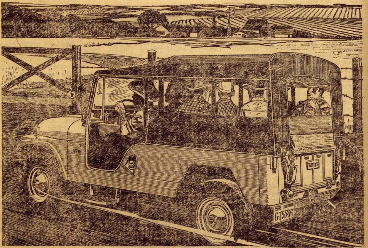
Oferece maior rendimento nas empresas que necessitam transporte sistemático de pessoal. Sua distância entre eixos, de 101 polegadas, lhe garante um rodar macio e grande estabilidade em qualquer tipo de estrada. 2 portas, assentos para 8 passageiros. Apresentado em 2 modelos: tração nas 4 rodas e reduzida ou tração em 2 rodas somente.
